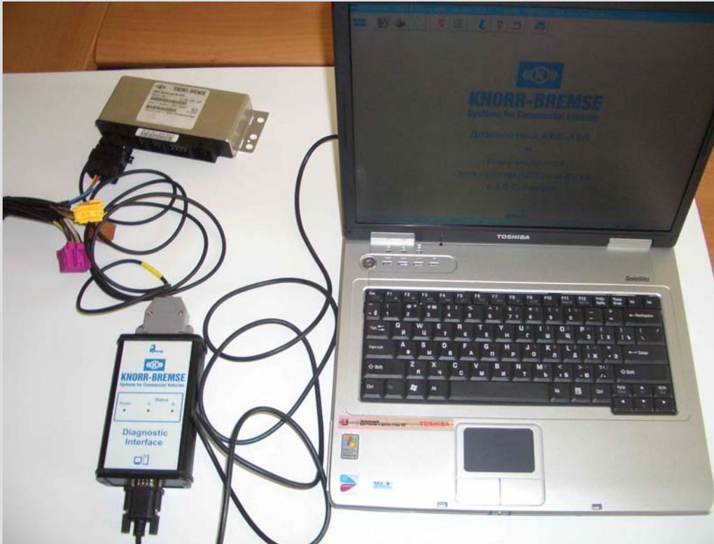
Вам необходимо подсоединить UDIF 9-штырьковый коннектор D-типа к любому COM порту компьютера. Программное обеспечение автоматически определит, где произведено подключение UDIF.
